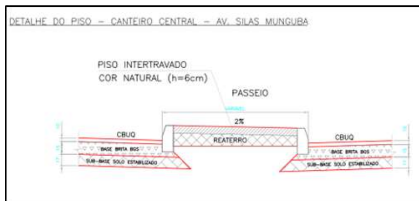
Figura 04: Detalhe do canteiro central
